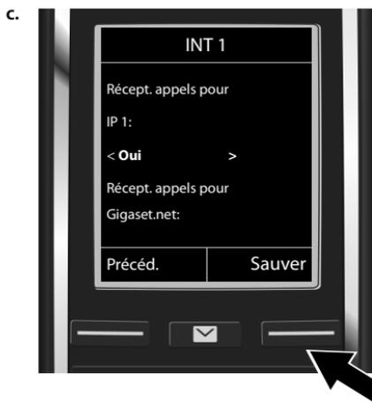
Pour qu'aucun appel ne soit signalé sur la connexion VoIP IP1 du combiné :
