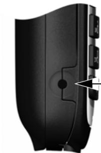
Vous pouvez raccorder un kit oreillette à l'aide d'une prise de 2,5 mm. Des recommandations sur les kits oreillette sont disponibles sur la page relative à l'appareil sur [www.gigaset.com](http://www.gigaset.com).
