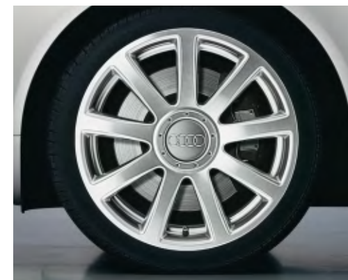
Jantes en aluminium forgé Audi exclusive style 9 branches, polies brillant, monochromes, 9 J x 20 avec pneus 275/35 R 20, incluant roue de secours temporaire. Une offre de quattro GmbH
