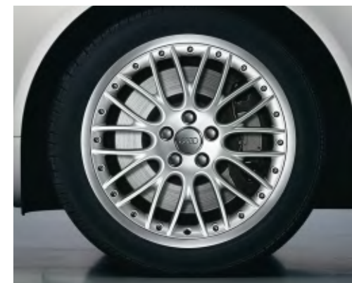
Jantes en aluminium coulé Audi exclusive style 20 rayons, en deux parties, 9 J x 19 avec pneus 255/40 R 19. Une offre de quattro GmbH
