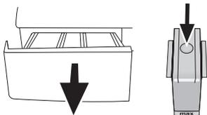
1. Appuyez sur le pointillé au-dessus du siphon dans le compartiment destiné à l'assouplissant, puis tirez vers vous jusqu'à ce que le compartiment soit enlevé de la machine.
