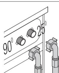
1. Raccordez les tuyaux spéciaux fournis avec la machine aux vannes d'arrivée d'eau de la machine. Le tuyau rouge (à gauche) (max. 90 °C) est celui d'arrivée d'eau chaude et le tuyau bleu (à droite) (max. 25 °C) est celui d'arrivée d'eau froide.
