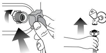
3. Ouvrez les robinets complètement après avoir raccordé les tuyaux pour vérifier si de l'eau ne fuit pas par les points de raccordement. Si vous constatez des fuites, fermez le robinet et retirez l'écrou. Resserrez l'écrou soigneusement après avoir vérifié le joint. Pour éviter toute fuite d'eau ou dégât consécutif, laissez les robinets fermés lorsque la machine n'est pas utilisée.
