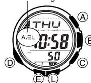
Un panneau EL (électroluminescent) éclaire tout l'afficheur de la montre pour qu'il soit mieux visible dans l'obscurité. L'autocommutateur d'éclairage de la montre s'active lorsque vous tournez la montre vers votre visage et à ce moment l'afficheur s'éclaire.
