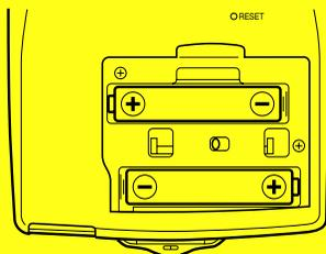
4. Replacez le couvercle du logement des piles sur l'appareil PV en veillant à ne pas abîmer les pattes.
