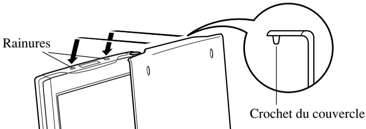
2. Rabattez le couvercle et appuyez sur le bas de l'appareil PV de sorte que le couvercle s'enclenche.
