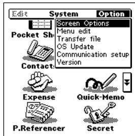
4. Tapez sur **Transfer file** pour mettre l'appareil PV en attente de réception.
