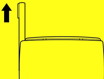
7. Tout en appuyant légèrement sur le centre du couvercle, tirez le bas du couvercle avec vers le haut et levez le couvercle pour le détacher.
