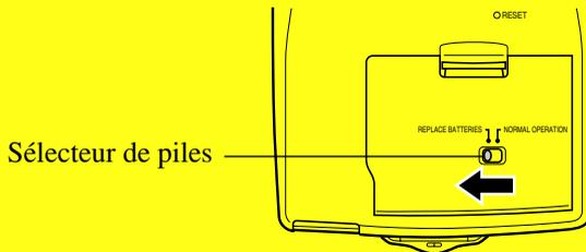
2. Tirez l'onglet du couvercle du logement des piles avec les doigts pour le libérer et ouvrez le couvercle.
