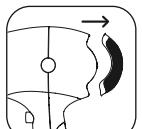
• Afneembaar rooster achterzijde: door het bevestigingssysteem met magneten kan het rooster aan de achterzijde zeer eenvoudig verwijderd en teruggeplaatst worden, om het reinigen te vereenvoudigen.
