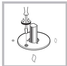
5. Als de regeling voltooid is moet u de zegels op de bypass schroefjes weer op hun plaats brengen met zegellak of dergelijk materiaal.
