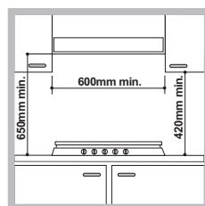
Якщо плита встановлюється під шафою, тоді відстань між шафою і плитою має бути мінімум 700 мм.
