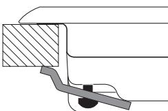
Posición del gancho para superficies  $H=20\text{mm}$
