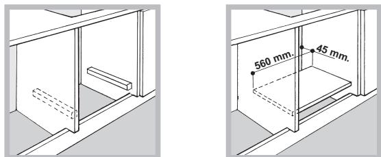
! Het is alleen mogelijk de kookplaat boven inbouwovens te installeren als deze zijn voorzien van afkoelingsventilatie.
