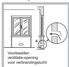
Dit systeem kan worden uitgevoerd door lucht direct van buiten te onttrekken door middel van een buis met een doorsnede van minstens 100 cm<sup>2</sup> en die zodanig is geplaatst dat hij niet per ongeluk verstopt kan raken.
