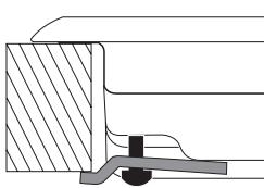
Розташування кріплення до стельниці  $H=40\text{mm}$
