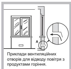
Система циркуляції повітря може отримувати повітря безпосередньо з навколошнього середовища задопомогою труб з внутрішнім перерізом не менше 100см<sup>2</sup>; отвори не повинні бути уразливі до будь-якого блокування.
