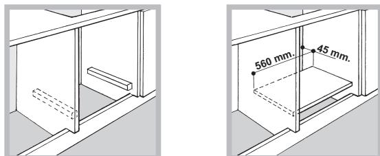
**! É possível instalar o plano somente sobre fornos de encaixe equipados com ventilação de arrefecimento.**
