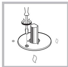
5. Після коригування параметрів, необхідно замінити прокладки використовуючи сургуч або аналогічну речовину.
