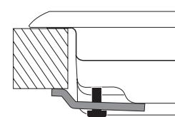
Çalışma tezgahı için kanca pozisyonu H=30mm
