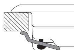
Çalışma tezgahı için kanca pozisyonu H=20mm
