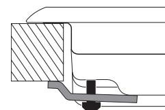
Posición del gancho para superficies  $H=30\text{mm}$
