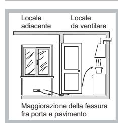
Ovvero, in maniera indiretta da locali adiacenti, dotati di un condotto di ventilazione con l'esterno come sopra descritto, e che non siano parti comuni dell'immobile, o ambienti con pericolo di incendio, o camere da letto.
