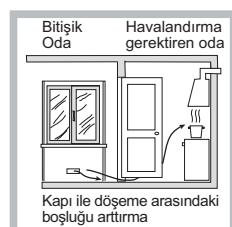
Veya, dolaylı olarak, bitişik mekânlarda mevcut olan yukarıda anlatılan türden bir dışarıya açılma sistemi bulunan bir havalandırma borusu kullanılabilir; bu havalandırma borusu gayri menkulün müsterek kullanımında, ya da yanın tehlikesi olan mekânlarda ya da yatak odalarında olmamalıdır.
