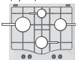
O aspecto mais variável em termos de estabilidade das panelas depende na maioria das vezes da própria panela (ou do seu posicionamento durante o uso). Panelas bem equilibradas, com fundo plano, centradas no queimador e com as pegas alinhadas com uma das linhas da grelha oferecem obviamente a máxima estabilidade.
