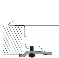
Çalışma tezgahı için kanca pozisyonu H=40mm
