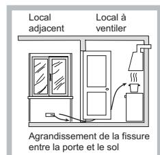
Ou, de manière indirecte depuis des locaux adjacents et équipés d'un conduit de ventilation avec l'extérieur comme susmentionné; ces locaux ne doivent pas être des parties communes du bâtiment, des chambres à coucher ou des locaux à risque d'incendie.
