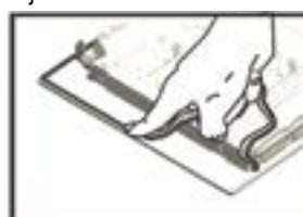
Coloque las juntas suministradas con el aparato en los bordes externos de la encimera para impedir el paso de aire, humedad y agua (ver la figura). Para que la aplicación sea correcta, controle que las superficies que se deben sellar estén limpias, secas y sin grasa o aceites.
