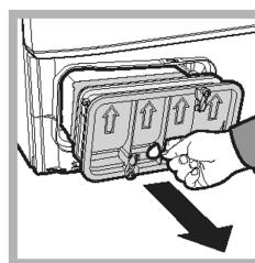
Nettoyez la surface des joints et remettez le condenseur en place : les flèches doivent être orientées vers le haut. Assurez-vous que les loquets sont bien clipsés.
