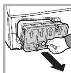
Maak het oppervlak van de dichtingringen schoon en vervang met de pijltjes naar boven gericht. Zorg ervoor dat alle clips vergrendeld zijn.
