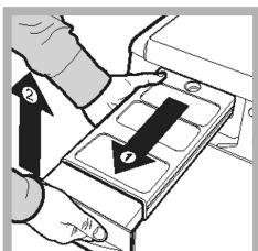
Tirez le réservoir pour l'extraire du sèche-linge et retirez le petit capot ou le grand capot, videz-le dans un évier ou autre, pour en éliminer le contenu. Remettez en place le capot et remettez le réservoir bien en place.
