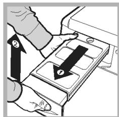
Trek de container uit de droogautomaat en verwijder ofwel de kleine of de grote klep. Giet de container leeg in een wasbak of een andere geschikte afvoer. Bevestig de klep terug, plaats de container terug en zorg ervoor dat hij goed vastzit.
