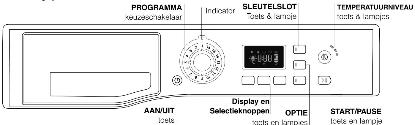
De toets **AAN/UIT** : Als de droger werkt en er gedurende langer dan 3 seconden op deze knop wordt gedrukt, wordt de droger uitgeschakeld. Er wordt afgeteld: 3, 2, 1, Uit en vervolgens wordt het programma geannuleerd.
