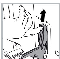
2. Levantar los ganchos de extracción ubicados en las dos bisagras. Si no se logra levantarlos manualmente, hacer palanca con una herramienta.
