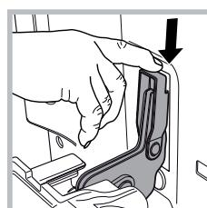
5. Tourner vers le haut les crochets d'extraction jusqu'au contact avec la façade du four.
