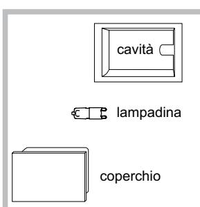
Per sostituire la lampadina di illuminazione del forno:
