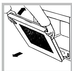
4. Prendre la porte sur les deux bords externes, en la refermant lentement mais pas entièrement. Puis tirer la porte vers soi en l'extrayant de son logement (cf. figure). Remonter la porte en suivant la procédure dans le sens inverse.
