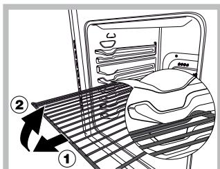
**ATTENZIONE!** Il forno è dotato di un sistema di arresto griglie che consente di estrarre senza che queste fuoriescano dal forno. (1) Per estrarre completamente le griglie è sufficiente, come indicato sul disegno, alzarle, prenderle dalla parte anteriore e tirarle. (2)
