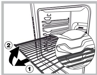
**ATENCIÓN!** El horno está dotado de un sistema de bloqueo de las parrillas que permite quitarlas sin que sobresalgan del horno (1). Para quitar completamente las parrillas, como se indica en el dibujo, es suficiente levantarlas cogiéndolas de la parte delantera y tirar (2).
