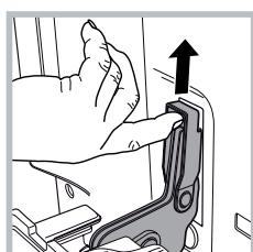
2. Enlever les crochets d'extraction placés sur les deux charnières. S'il n'est pas possible de le lever manuellement, faire levier avec un outil.
