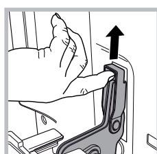
2. Alzare i ganci di estrazione posti sulle due cerniere. Se non si riesce ad alzarli manualmente, fare leva con un utensile.
