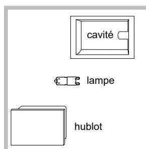
Pour changer l'ampoule d'éclairage du four:
