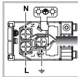
2. Instalar el cable de alimentación eléctrica: Aflojar el tornillo de la mordaza de terminal de cable y los tres tornillos de los contactos L-N- $\text{--}$  y luego fijar los cables debajo de las cabezas de los tornillos respetando los colores Azul (N), Marrón (L) y Amarillo-Verde  $\text{--}$  (ver la figura).
