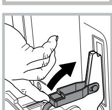
5. Girar hacia arriba los ganchos de extracción hasta que queden en contacto con la fachada del horno.
