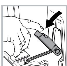
3. Girar completamente hacia abajo los ganchos de extracción.
