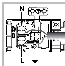
2. Mettere in opera il cavo di alimentazione: svitare la vite del serracavo e le tre viti dei contatti L-N-— e poi fissare i cavetti sotto le teste delle viti rispettando i colori Blu (N) Marrone (L) Giallo-Verde — (vedi figura).
