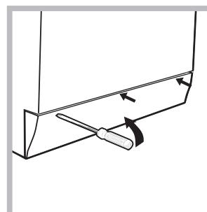
3. verwijder het afdekpaneel aan de voorkant van de wasautomaat met behulp van een schroevendraaier (zie afbeelding).
