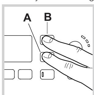
Pour activer le programme, appuyer simultanément sur les touches **A** et **B** pendant 5 secondes (*voir figure*). Le programme déarrera automatiquement et durera environ 70 minutes. Pour stopper le cycle, appuyer sur la touche START/PAUSE.
