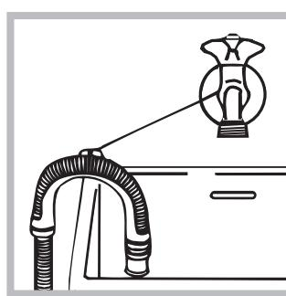
of hang hem aan de rand van een wasbak of badkuip, en bind de bijgeleverde steun aan de kraan (zie afbeelding). Het uiteinde van de afvoerslang mag niet onder water hangen.
