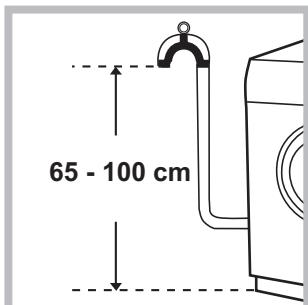
Schließen Sie den Ablaufschlauch, ohne ihn dabei zu knicken, an eine Ablauflleitung, oder an einen in der Wand, in einer Höhe von 65cm bis 100cm an;
