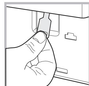
4. se servir de la languette indiquée, tirer vers soi jusqu'à ce que le tirant en plastique se dégage de son cran d'arrêt; tirer ensuite vers le bas et ouvrir l'hublot en même temps.
