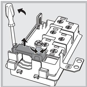
2. Desatarraxe o parafuso da braçadeira e tire-o utilizando uma chave de fendas (veja a figura).
