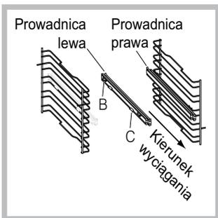
2. Escolher a prateleira na qual inserir a guia. Prestando atenção ao sentido de extração da guia, posicione no quadro antes o encaixe B e depois o encaixe C.
