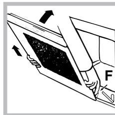
3. segure a porta dos dois lados exteriores e feche-a novamente devagar mas não inteiramente; Pressione os grampos **F**, em seguida puxe a porta para a frente e retire-a das dobradiças (veja a figura). Para montar novamente a porta realize, na ordem contrária, as mesmas operações.
