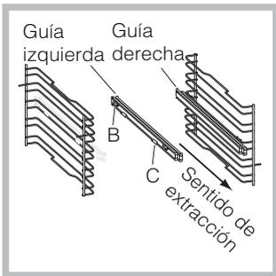
2. Elija el nivel en el que va a introducir la guía deslizable. Prestando atención al sentido de extracción de dicha guía, coloque sobre el bastidor la ensambladura B primero y luego la C.
