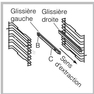
2. Choisir le gradin sur lequel monter la glissière coulissante. Positionner sur le cadre d'abord le dispositif de fixation B puis le C en veillant à bien respecter le sens d'extraction de la glissière.
