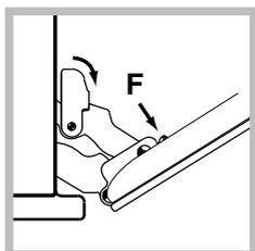
2. alzare e ruotare le levette poste sulle due cerniere (*vedi figura*);
