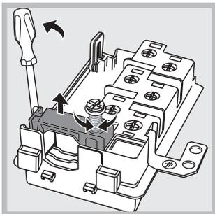
2. Desenrosque el tornillo de la mordaza de terminal de cable y extráigalo haciendo palanca con un destornillador (*ver la figura*).
