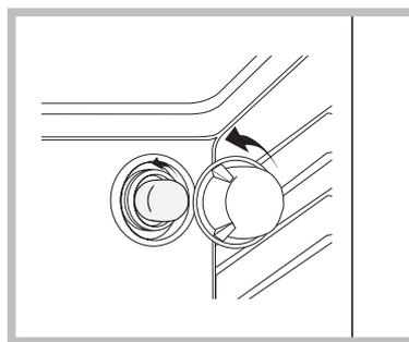
1. Retire a tampa de vidro, utilize uma chave de parafuso.
