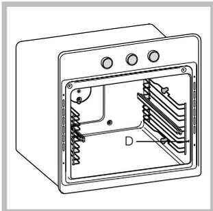
3. Fije los dos bastidores, con las guías montadas, en los orificios correspondientes ubicados en las paredes del horno (*ver la figura*). Los orificios para el bastidor izquierdo están
