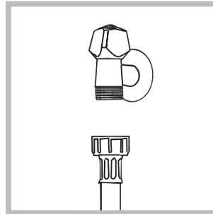
1. Sluit de toevoerbuis aan op de koudwaterkraan met een mondstuk met schroefdraad van 3/4 gas (zie afbeelding). Voordat u de wasautomaat aansluit moet u het water laten lopen totdat het helder is.
