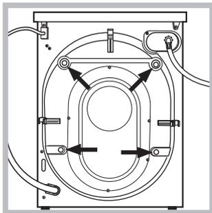
3. Verwijder de 4 schroeven die het apparaat beschermen tijdens het vervoer en de rubberen ring met bijbehorende afstandsleder die zich aan de achterkant bevinden (zie afbeelding).
