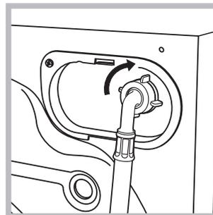
2. Das andere Ende des Schlauches an den oben rechts am Rückteil des Waschvollautomaten befindlichen Wasseranschluss anschließen (siehe Abbildung).
