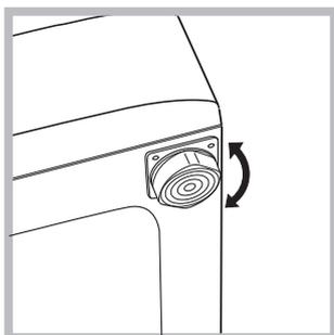
2. Als de vloer niet volledig horizontaal is kunt u de onregelmatigheid opheffen door de stelvoetjes aan de voorkant losser of vaster te schroeven (zie afbeelding); de inclinatiehoek, gemeten ten opzichte van het werkvlak, mag de 2° niet overschrijden.
