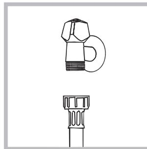
1. Reliez le tuyau d'alimentation en le vissant à un robinet d'eau froide à embout fileté 3/4 gaz (voir figure). Faire couler l'eau jusqu'à ce qu'elle soit limpide et sans impuretés avant de raccorder.
