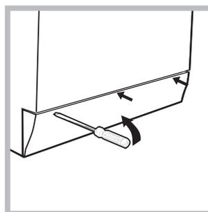
3. tire o painel de cobertura da parte dianteira da máquina de lavar roupa com ajuda de uma chave de fendas(veja a figura).
