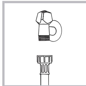
1. Schrauben Sie den Wasserschlauch an einen Kaltwasserhahn mit 3/4-GAS-Gewindeanschluss an (siehe Abb.).
