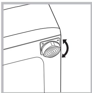
2. Sollte der Boden nicht perfekt eben sein, müssen die Unebenheiten durch An- bzw. Ausdrehen der vorderen Stellfüße ausgeglichen werden (siehe Abbildung), der auf der Arbeitsfläche zu ermittelnde Neigungsgrad darf 2° nicht überschreiten. Eine präzise Nivellierung
