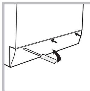
3. Nehmen Sie die Abdeckung (befindlich an der Gerätefront) mit Hilfe eines Schraubenziehers ab (*siehe Abbildung*).
