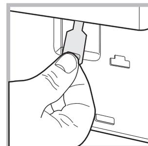
4. Befreien Sie mithilfe der auf der *Abbildung* veranschaulichten Zunge (nach vorne ziehen) die Kunststoff-Spannvorrichtung aus der Arretierung; ziehen Sie letztere dann nach unten und öffnen Sie gleichzeitig die Gerätetür.
