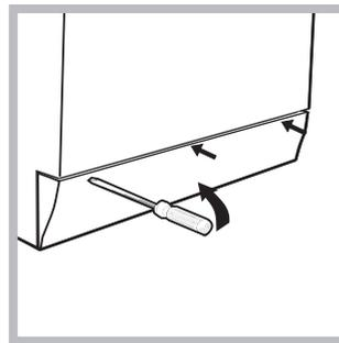
1. Nehmen Sie die Abdeckung (befindlich an der Gerätefront) mit Hilfe eines Schraubenziehers ab (siehe Abbildung);
