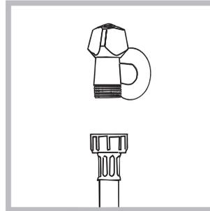
1. Realize a ligação do tubo de alimentação parafusando-o a uma torneira de água fria com bocal de rosca de 3/4 gás (veja a figura).
