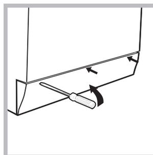
3. verwijder het afdekpaneel aan de voorkant van de wasautomaat met behulp van een schroevendraaier (zie afbeelding).
