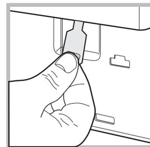
4. trek het lipje dat wordt aangegeven in de afbeelding naar voren totdat het plastic bandje loskomt; trek hem daarna naar beneden en open tegelijkertijd de deur.
