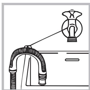
o apóyelo en el borde de un lavamanos o de una bañera, uniendo la guía suministrada con el aparato, al grifo (ver la figura). El extremo libre del tubo de descarga no debe permanecer sumergido en el agua.
