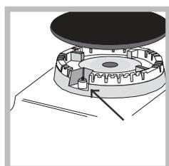
Si l'appareil est équipé d'un allumage électronique\* (*voir figure*) il suffit de pousser et de tourner en même temps dans le sens inverse des aiguilles d'une montre le bouton BRULEUR sur le symbole petite flamme,
