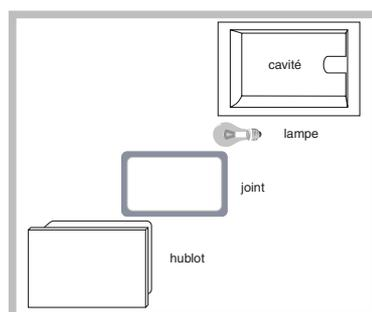
Pour changer l'ampoule d'éclairage du four :
