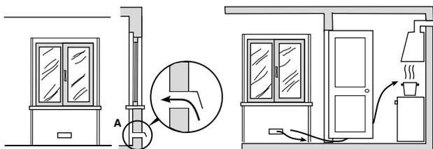
Ouverture de ventilation pour l'air comburant
