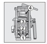
■ Nettoyez l'écrou ① et graissez-le ainsi que les articulations ② avec un peu de graisse au sili-cone.
