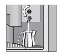
■ Faites tourner la verseuse jusqu'à ce qu'une mousse dense se soit formée puis plongez la buse de production de mousse complètement dans le lait jusqu'à ce que celui-ci soit chaud.
