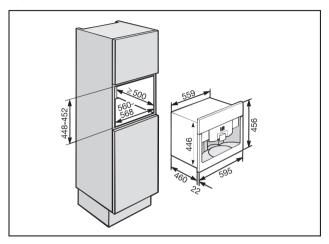
De par son design et son exécution, il est possible de l'installer en combinaison avec d'autres appareils encastrables MIELE. Dans ce cas, il est cependant extrêmement important que l'appareil soit isolé en partie inférieure par une tablette intermédiaire complètement fermée (sauf en cas de combinaison avec un tiroir chauffant télescopique).
