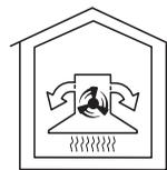
L'air est aspiré dans les filtres à graisse et un **filtre à charbon actif**. L'air filtré est ensuite recirculé dans la cuisine par un conduit se trouvant au haut de la cheminée de la hotte.
