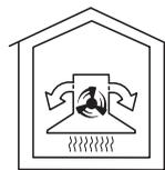
L'air est aspiré dans les filtres à graisse et un **filtre à charbon actif**. L'air filtré est ensuite recirculé dans la cuisine par une conduite se trouvant au-dessus de la cheminée de la hotte.
