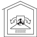
L'air est aspiré dans les filtres à graisses et dans des **filtres à charbon actif**. L'air filtré est ensuite recirculé dans la cuisine par une conduite située au-dessus de la cheminée de la hotte.
