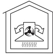
L'air est aspiré dans les filtres à graisse et un **filtre à charbon actif**. L'air filtré est ensuite recirculé dans la cuisine par une conduite se trouvant au-dessus de la cheminée de la hotte.
