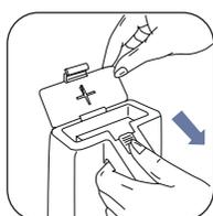
Tirer sur le verrou et ouvrir le volet du compartiment bloc batterie.
