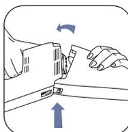
Engager le bac réceptacle sur le bloc moteur et le faire basculer vers l'avant. Un déclic signale le verrouillage.
