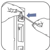
Le fixer au mur à l'aide des vis et chevilles fournies avec l'appareil\*. Avant la fixation, enrrouler au dos du support la longueur de cordon inutilisée. Brancher le chargeur.
