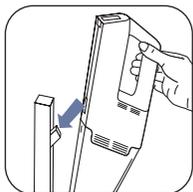
Placer l'appareil sur le support\*, engager la prise de connection jusqu'au déclic.
