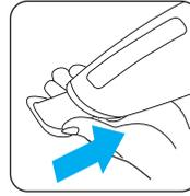
Pour les liquides sur les surfaces lisses, placez la raclette à liquides\* dans l'ouverture d'aspiration.
