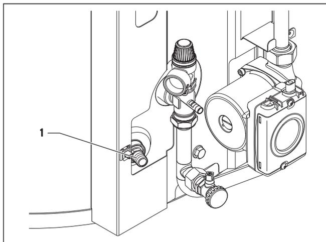
Abb. 4.2 Soupape de vidange pour ballon d'eau potable
