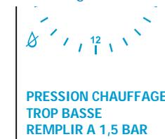
La chaudière s'est mise en sécurité parce qu'elle a détecté un manque d'eau dans l'installation.
