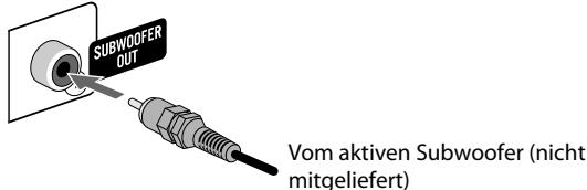
Der angeschlossene Subwoofer kann die Tiefentöne reproduzieren, die in den vorderen linken und rechten Kanälen aufgenommen wurden, kann aber nicht die in Mehrkanal-Material eingebetteten LFE-Signale reproduzieren.
