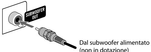
Il subwoofer collegato è in grado di riprodurre le basse frequenze registrate nei canali anteriori sinistro e destro, ma non i segnali LFE codificati nei software multicanale.
