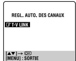
Les positions pré-réglées indiquées sur le panneau d'affichage croissent à partir de "CH1"; ne PAS appuyer sur des touches du magnétoscope ou de la télécommande avant que le panneau d'affichage montre l'heure, "(CH) 1" ou "--:--" comme illustré à la page 17.
