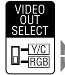
**Y/C** Kies voor het versturen van S-videosignalen via de AV OUT aansluiting of voor het versturen van componentvideosignalen via de COMPONENT aansluitingen.
