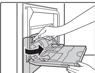
Poussez le levier en haut du plateau vers la gauche pour débloquer le système de verrouillage.
