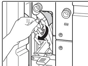
Une fois relâché, le levier U7 se remet automatiquement dans sa position initiale. Une fois le papier retiré, remplacez le levier U3 dans sa position initiale.
