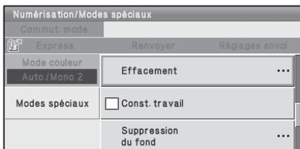
Si vous sélectionnez un mode spécial comportant une case à cocher (), celle-ci devient  une fois le réglage terminé. Lorsque vous avez sélectionné une autre touche de mode spécial, un écran apparaît pour vous permettre de sélectionner les réglages correspondant à ce mode. Les touches qui apparaissent varient selon les pays et régions, et les périphériques qui sont installés.
