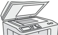
Si la dimension X (largeur) du document est inférieure à 89 mm (3-1/2") ou si la dimension Y (hauteur) est inférieure à 100 mm (4"), placez le document sur la vitre d'exposition. Lorsque vous utilisez le chargeur automatique de documents, utilisez le "Mode num. lente" en cas d'original fin.
