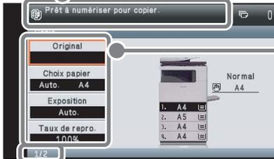
Zone d'affichage des paramètres. Si vous appuyez sur la touche (V) lorsque le cadre de sélection se trouve sur le paramètre du bas, l'écran suivant s'affiche.
