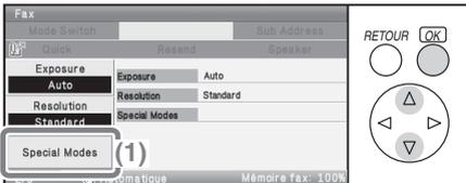
Pour utiliser un mode spécial, ouvrez le menu des modes spéciaux et sélectionnez mode souhaité. Le menu est composé de cinq écrans. Utilisez les touches  $\nabla$   $\triangle$  pour passer d'un écran à l'autre. Sélectionnez la touche [Modes spéciaux] sur l'écran initial pour ouvrir le menu des modes spéciaux.
