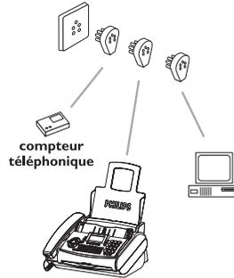
Dans plusieurs pièces : Vous pouvez raccorder les appareils supplémentaires à des prises séparées. Il s'agit alors d'un branchement en parallèle. Dans ce cas, le fonctionnement du système de gestion d'appels est limité, par exemple vous ne pouvez pas recevoir des télécopies silencieusement.
