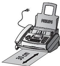
Évitez d'utiliser l'appareil en exposition directe au rayonnement du soleil. Ne le placez pas à proximité d'un chauffage, d'une radio, d'un téléviseur ou d'un appareil de climatisation. Ne l'exposez pas à la poussière, à l'eau ou à des produits chimiques.
