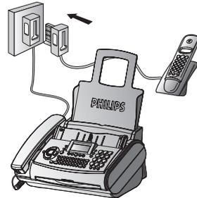
Dans plusieurs pièces : Vous pouvez raccorder les appareils supplémentaires à des prises séparées. Il s'agit alors d'un branchement en parallèle. Dans ce cas, le fonctionnement du système de gestion d'appels est limité, par exemple vous ne pouvez plus recevoir des télécopies silencieusement.
