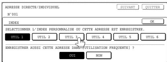
Sélectionnez l'une des touches de la rangée supérieure (UTIL 1 à UTIL 6) pour déterminer à quel emplacement cette touche d'accès rapide doit apparaître lorsqu'on affiche l'index des GROUPES, et non l'index ABC (voir page 7). Les touches du bas servent à spécifier si cette touche doit être incluse dans l'index USAGE FREQ.. Si vous effleurez une touche par erreur, il suffit d'effleurer ensuite la bonne touche pour corriger l'erreur.
