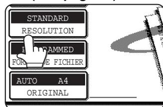
La valeur de réglage par défaut (en sortie d'usine) de la résolution est STANDARD.
