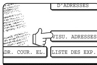
Lorsqu'on effleure la touche VISU. ADRESSES, seules les destinations sélectionnées apparaissent à l'écran. Si vous avez besoin d'en retirer une de la liste, effleurez cette dernière. Appuyez sur OK pour retourner à l'écran initial.
