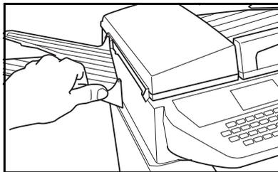
☛ Fixez sur le côté gauche du télécopieur le réceptacle de sortie pour le document original en enclenchant les deux ergots dans les orifices prévus à cet effet.
