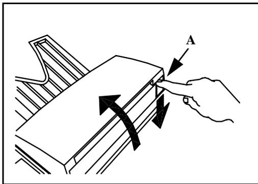
☞ Ouvrez le capot analyse du scanner à défilement, en appuyant sur le bouton (A).
