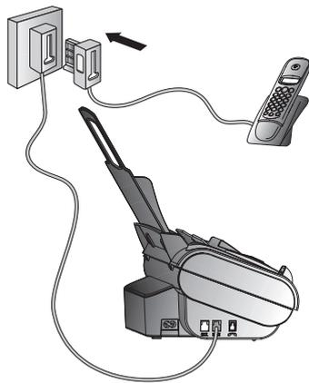
Dans plusieurs pièces: vous pouvez raccorder les appareils supplémentaires à des prises séparées. Il s'agit alors d'un branchement en parallèle. Dans ce cas, le fonctionnement du système de gestion d'appels est limité, par exemple vous ne pouvez plus recevoir des télécopies silencieusement.
