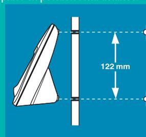
Percez dans le mur deux trous alignés verticalement, distants de 122 mm et installez les chevilles et les vis de diamètre 4 millimètres (non fournies).
