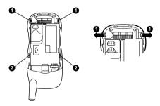
■ Dégagez la face avant en écartant si nécessaire les pattes de fixation (②) et en poussant dessus à l'aide d'un stylo par exemple.
