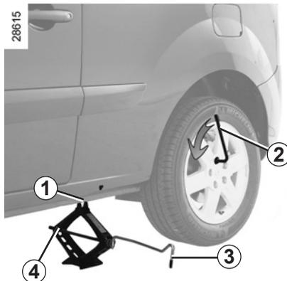
Débloquez les vis de la roue à l'aide de la clé de roue **2**. Positionnez-la de façon à appuyer dessus.
