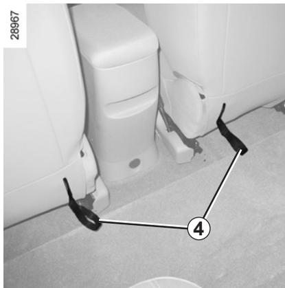
Pour basculer le siège avant depuis les places arrière, tirez sur la sangle 4 et faites coulisser le siège vers l'avant.
