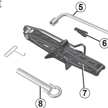
**Guide vis 6 (suivant véhicule)**
