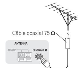
Pour améliorer la qualité de la réception AM, raccordez un fil à gaine en vinyle de 5 m à 6 m de long aux bornes **AM LOOP** sans débrancher l'antenne cadre AM fournie.
