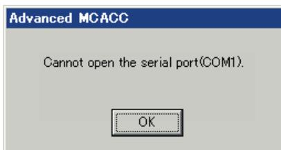
Se reporter au manuel d'utilisation de l'ordinateur ou au logiciel d'application utilisant le port COM, et rendre la connexion du port COM disponible pour la transmission.
