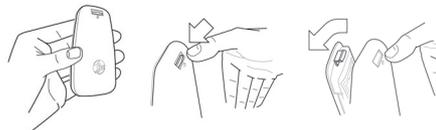
Le clavier se détache du dos de l'appareil, comme le montre le schéma. Veuillez à ne pas faire tomber le clavier.
