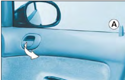
Ouverture des portes de l'intérieur
