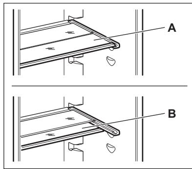
Les parois du réfrigérateur sont équipées d'une série de supports afin que les clayettes puissent être positionnées comme vous le souhaitez.
