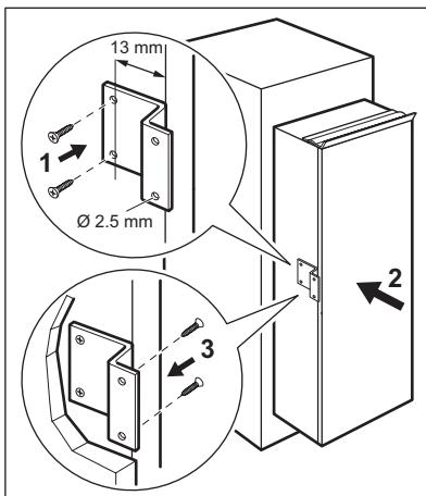
Forare con una punta da trapano di Ø 2,5 mm (profondità max 10 mm).
