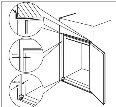
Posizionare correttamente l'apparecchiatura nella nicchia. Assicurarsi che la distanza tra l'apparecchiatura ed il bordo anteriore dell'armadio sia di 4 mm. Il copricerniere inferiore (incluso nel sacchetto degli accessori) permette di controllare che la distanza fra l'apparecchiatura ed il mobile della cucina sia corretta. Accertarsi che lo spazio fra l'apparecchiatura e il mobile sia di 4 mm. Aprire la porta. Applicare il copricerniere inferiore.
