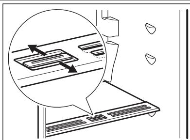
Il ripiano di vetro incorpora un dispositivo a fessure, regolabili per mezzo di una leva scorrevole, che consente di regolare la temperatura del cassetto o dei cassetti delle verdure.
