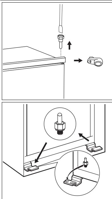
La porta dell'apparecchiatura si apre verso destra. Se si desidera che la porta si apra verso sinistra, prima di installare l'apparecchiatura eseguire queste operazioni:
