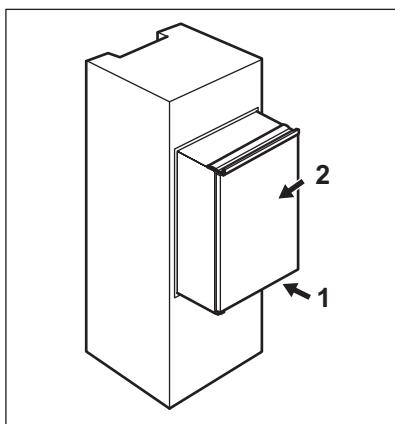
Insérez l'appareil dans le meuble d'encastrement.
