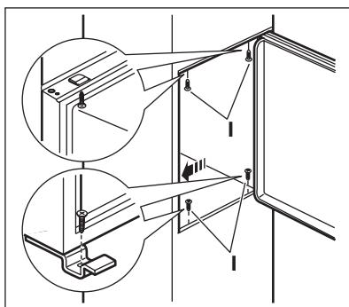
Fissare l'apparecchiatura nella nicchia con 4 viti.
