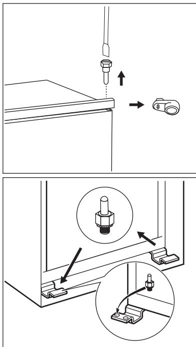
La porte de l'appareil s'ouvre vers la droite. Si vous souhaitez modifier le sens d'ouverture de la porte (vers la gauche), effectuez les opérations suivantes avant d'installer définitivement l'appareil :
