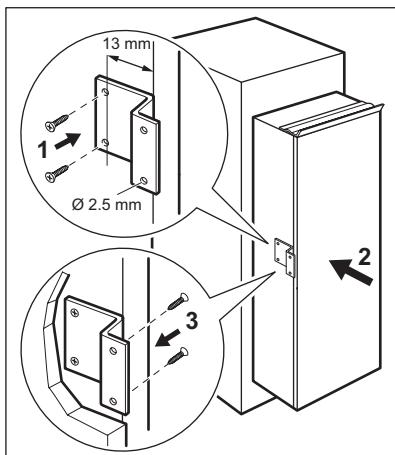
Percez l'appareil à l'aide d'un embout de Ø 2,5 mm (pénétration de 10 mm max.). Fixez l'attache carrée à l'appareil.
