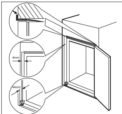
Ajustez la position de l'appareil dans le meuble d'encastrement.
