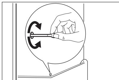
Durante l'uso normale, la brina viene eliminata automaticamente dall'evaporatore del vano frigorifero ogni volta che il motocompressore si arresta. L'acqua di sbrinamento giunge attraverso un condotto in un apposito recipiente posto sul retro dell'apparecchiatura, sopra il motocompressore, dove evapora.
