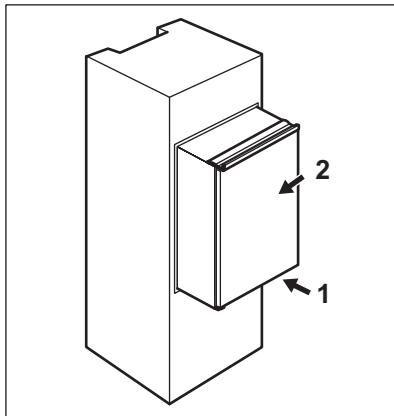
Installare l'apparecchiatura nella nicchia. Spingere l'apparecchiatura in direzione della freccia (1) finché la mascherina superiore si arresta contro il mobile da cucina. Spingere l'apparecchiatura in direzione della freccia (2) contro il mobile sul lato opposto rispetto alla cerniera.
