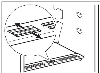
La clayette inférieure en verre est équipée d'un dispositif muni de fentes dont les ouvertures sont réglables à l'aide d'un levier coulissant, afin de réguler la température du bac à légumes.
