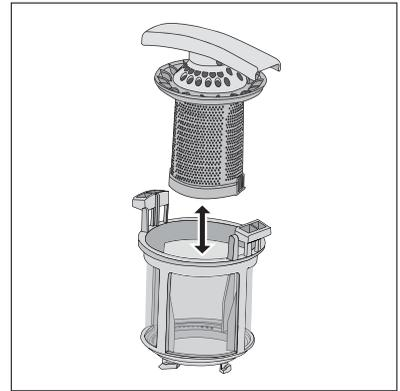
7. Remplacez le filtre (B) dans sa position initiale. Vérifiez qu'il est correctement emboîté dans les deux guides (C).
