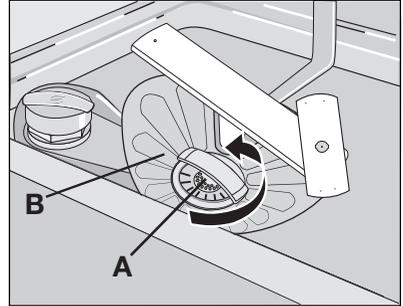
2. Le filtre (A) est constitué de 2 pièces. Pour démonter le filtre, séparez-les.
