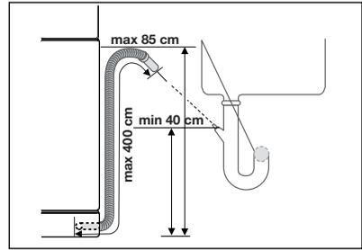
Verwijder het kunststofmembraan (A) als u de waterafvoerslang op een sifon onder de gootsteen aansluit. Als u het membraan niet verwijdert, kunnen voedselresten een verstopping in de slang veroorzaken.
