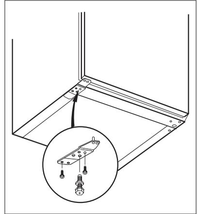
10. Nehmen Sie das Scharnier ab. Stecken Sie den Bolzen in Pfeilrichtung um. Befestigen Sie das Scharnier an der gegenüberliegenden Seite.
