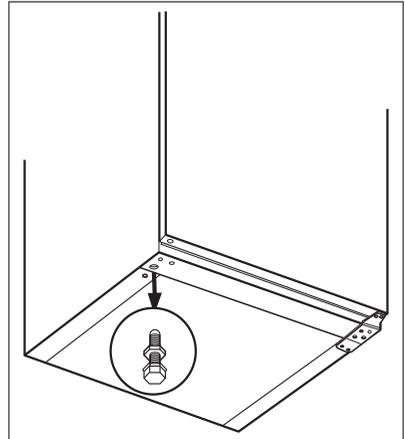
5. Dévissez les vis de la charnière inférieure de la porte. Retirez la charnière. Placez la goupille dans le sens de la flèche.
