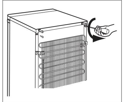
3. Schieben Sie die Arbeitsplatte nach hinten und heben Sie sie an.
