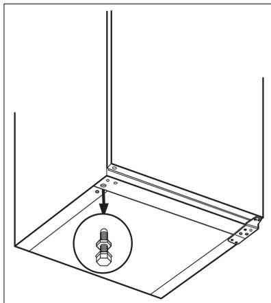
5. Lösen Sie die Schrauben des unteren Türscharniers. Nehmen Sie das Scharnier ab. Stecken Sie den Bolzen in Pfeilrichtung um.
