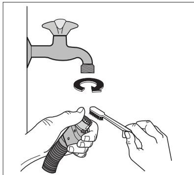
5. Dévissez le tuyau de l'appareil. Conservez à portée de main un chiffon car de l'eau peut s'écouler.
