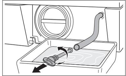
6. Quand l'eau ne sort plus, dévissez le couvercle de la pompe et retirez-le. Conservez toujours à portée de main un chiffon pour essuyer l'eau qui s'écoule de la pompe lors du retrait du couvercle.
