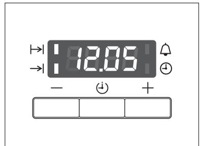
Le four s'allume automatiquement à l'heure sélectionnée, à 13:05 heures dans ce cas.
