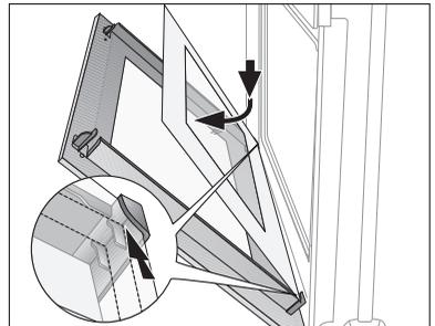
2. Saisissez le support de la porte (B) sur les côtés, appliquez-le dans sa position d'origine sur le bord intérieur de la porte et fixez-le sur l'arête supérieure de la porte..
