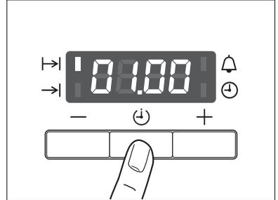
2. La fonction Fin [F] permet de régler l'heure à laquelle la préparation doit être cuite, 14:05 heures dans ce cas.
