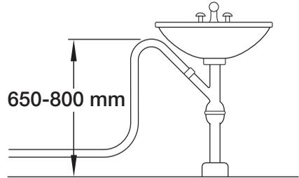
Vous pouvez connecter le tuyau d'évacuation directement à une conduite existante (sous le lavabo ou l'évier, par exemple) en amont du siphon. Disposez le tuyau de façon à ce que la crosse doit à 65 cm au moins du sol.
