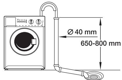
Le tuyau de vidange ne doit pas être enfoncé dans la conduite fixe de plus de 50 mm et il doit être fixé dans cette position. Le tuyau de vidange ne devra former aucun coude.
