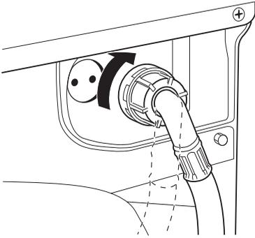
Le tuyau d'alimentation ne doit pas être allongé. S'il est trop court et que vous ne souhaitez pas déplacer le robinet, vous devrez acheter un nouveau tuyau conçu pour ce type d'utilisation.
