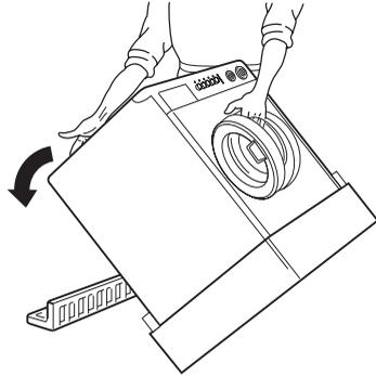
2. Remettez le lave linge d'aplomb. Retirez à l'arrière de l'appareil le câble d'alimentation électrique, les tuyaux d'arrivée d'eau et de vidange de leurs supports.
