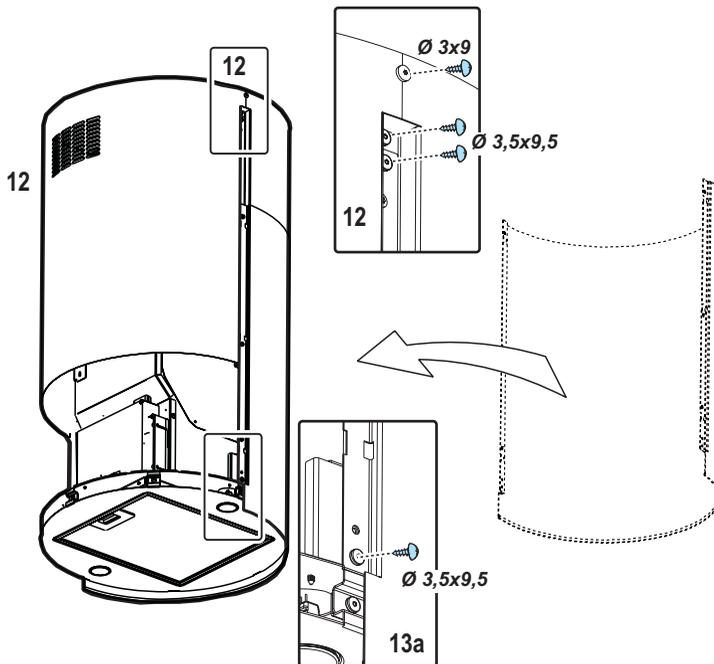
**b.** Appliquer la section inférieure/antérieure (AVEC panneau de contrôle) sur le côté antérieur de la hotte, (**b1**) effectuer le raccordement électrique entre la hotte et le panneau de contrôle, (**b2**) préfixer en position à l'aide de 2 vis (une par côté).
