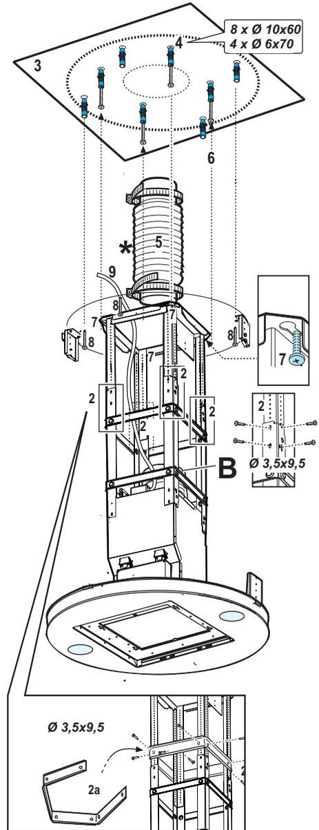
10. En cas de fonctionnement en **Versión évacuation extérieure (10A)**, raccordez l'autre extrémité du tuyau d'évacuation à la sortie d'air. En cas de fonctionnement en **Versión recyclage (10F)**, montez le déflecteur **F** sur la structure et fixez-le à la bride prévue à cet effet à l'aide de 2 vis puis raccordez le tuyau d'évacuation à la bague de raccordement située sur le déflecteur.
