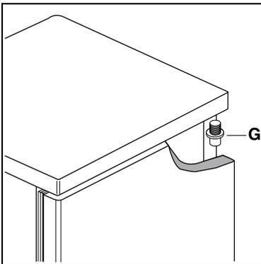
5. Dégagez la porte supérieure du pivot (G), dévissez ce dernier et vissez-le sur la charnière se trouvant sur l'autre côté, après avoir enlevé les caches, qui doivent être placés sur le côté opposé.
