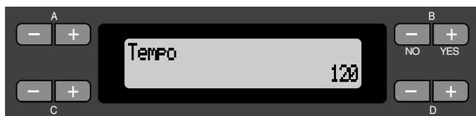
Pour régler le tempo (nombre de temps par minute : 10–400), utilisez les touches TEMPO [DOWN]/[UP] ou D [-]/[+]. Pour régler de nouveau le tempo sur la valeur normale (la valeur par défaut), appuyez simultanément sur les touches [DOWN] et [UP] ou D [-] et [+].
