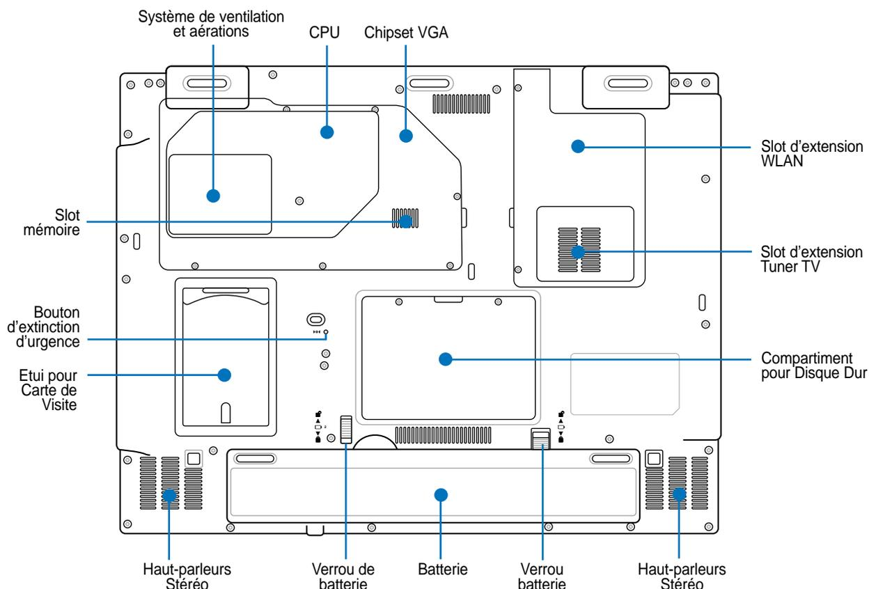
**ATTENTION!** Le dessous du portable peut être très chaud. Faites attention lorsque vous manipulez le portable et que celui-ci est en marche ou vient d'être éteint. Une température élevée est normale durant les phases de charge. **NE PLACEZ PAS LE PORTABLE DIRECTEMENT SUR VOS GENOUX OU TOUTE AUTRE PARTIE DE VOTRE CORPS POUR EVITER TOUT RISQUE DE BLESSURE.**
