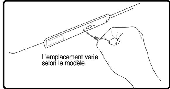
L'éjection d'urgence est une fente située sur le lecteur optique, utilisée pour éjecter le tiroir du lecteur optique lorsque l'éjection électronique ne fonctionne pas. N'utilisez pas l'éjection d'urgence à la place de l'éjection électronique. **Note: Assurez-vous de ne pas endommager l'indicateur d'activité situé dans la même zone.**
