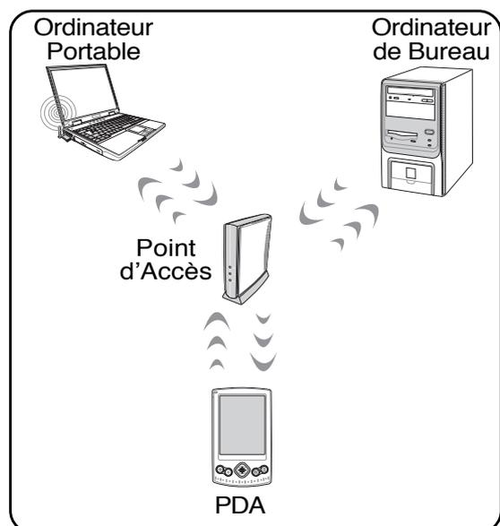
Voici des exemples de connexion entre l'Ordinateur Portable et un Réseau Sans-fil.
