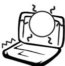
**NE PAS** exposer le portable à des températures supérieures à 50°C (122°F) ou à l'ensoleillement. Ne pas obstruer les entrées d'air!
